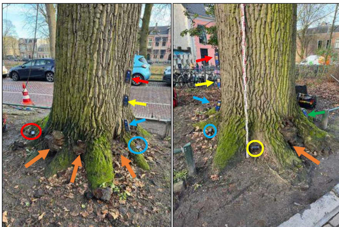
Foto 8 en 9: Links en rechts een foto van de sensorplaatsing. De locaties met harslakschimmiged worden aangegeven met oranje pijlen. De inclinometers zijn met cirkels weergegeven en de elastometers zijn met pijlen aangeduid. De kleur correspondeert met de kleurcodering in tabel 9.
